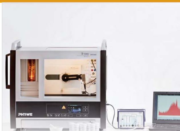
Качественный рентгеновский флуоресцентный анализ порошковых образцов
